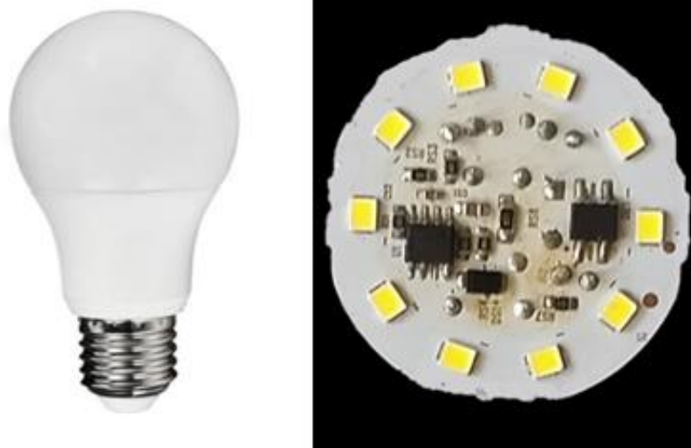
Figura 12 - Lâmpada utilizada para obtenção do led utilizado na iluminação do equipamento
