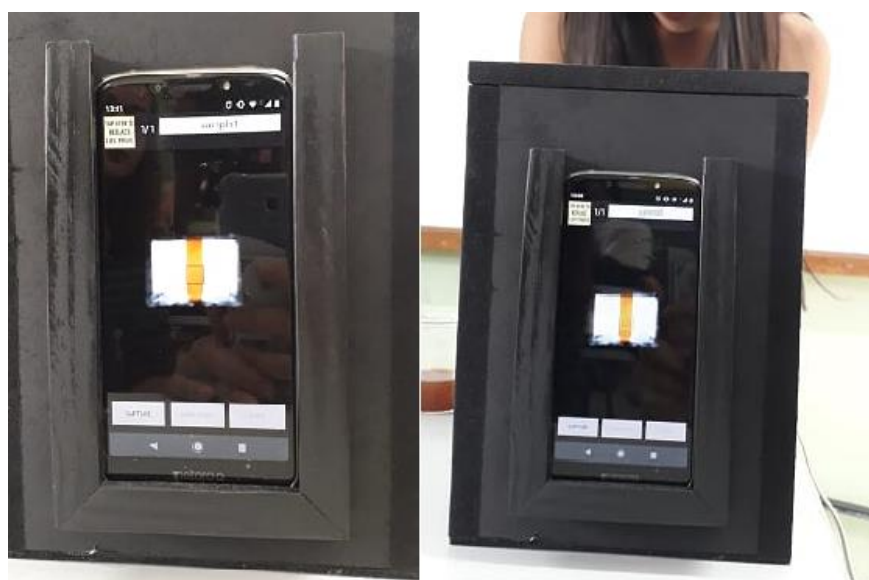
Figura 22 - Cabine de coleta de imagem digital sendo utilizada pelos alunos
