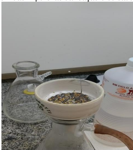
Figura 5: Filtragem das impurezas da reação e coleta do material filtrado
