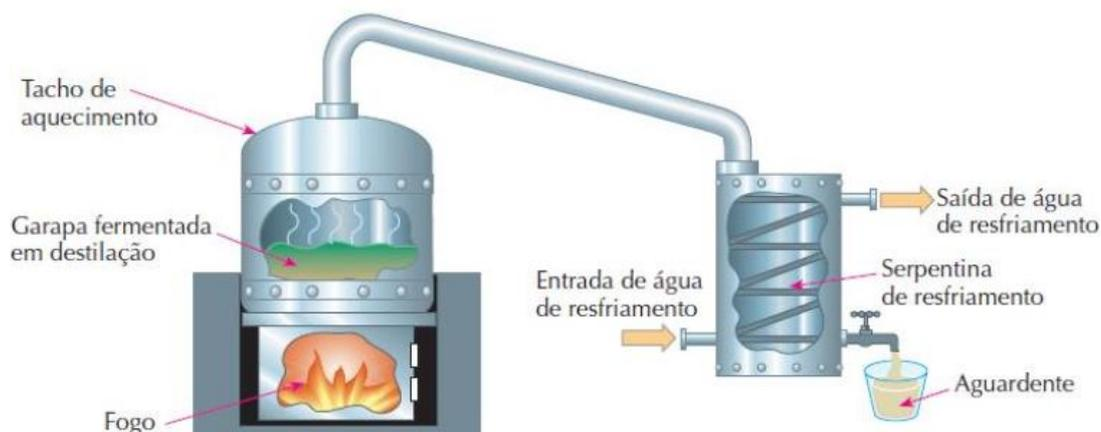
**Figura 1:** Esquema de um alambique para fabricação de aguardente
