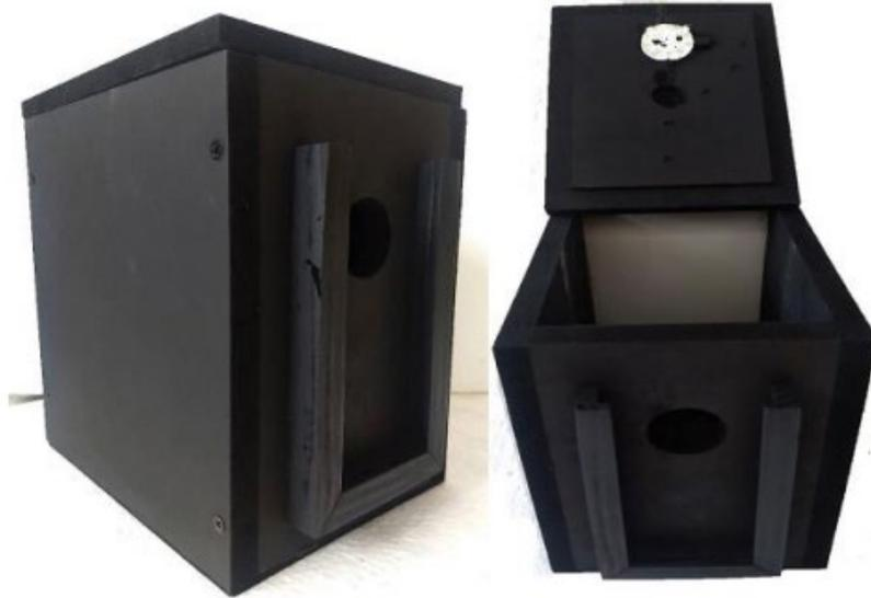
**Figura 1** - Equipamento utilizado para captação de imagens digitais
