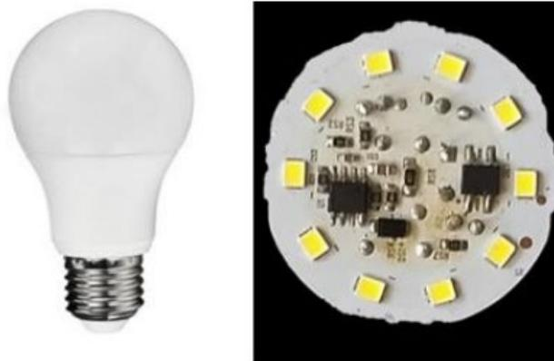
**Figura 4** - Lâmpada utilizada para obtenção do LED utilizado na iluminação do equipamento
