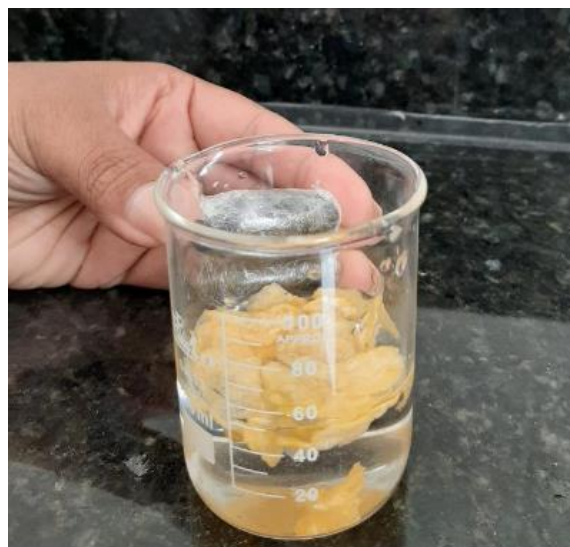
Figura 30: Flocos do cereal na água com aproximação do magneto Fonte: a autora
