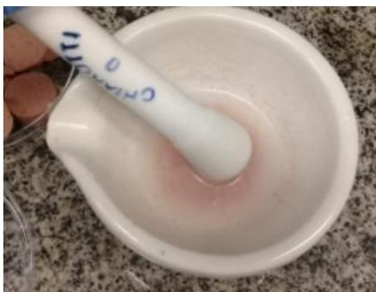
Figura 2. Procedimento de trituração das amostras
