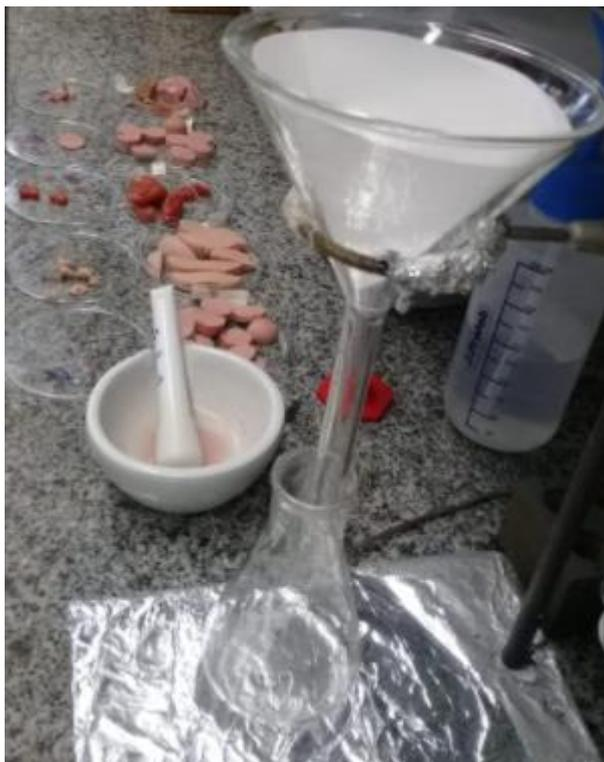
Figura 3. Filtração dos extratos das amostras
